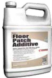
El aditivo para reparador de piso NA 501 es un aditivo de látex acrílico para su uso con el reparador de piso NA 500 para mejorar la adherencia y flexibilidad. Cuando NA 500 se mezcla con NA 501, el sistema de reparación de piso puede ser utilizado como un nivelador de relieves o para encapsular residuos de adhesivo asfáltico. NA 501 también aumenta el tiempo de trabajo de NA 500.
