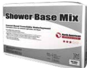
La mezcla para bases de duchas NA 1200 es una mezcla económica de arena selecta con cemento Portland. Mézclala con agua para crear un mortero para contrapisos semiseco de un espesor de 10 mm a 7,5 cm (3/8" a 3"). NA 1200 es excelente para nivelar pisos de concreto ásperos o desnivelados, y para crear inclinaciones en pisos de duchas y otras superficies antes de instalar losetas de cerámica o piedra.
